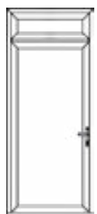
L'imposte (l'imposte peut également être cintrée)
