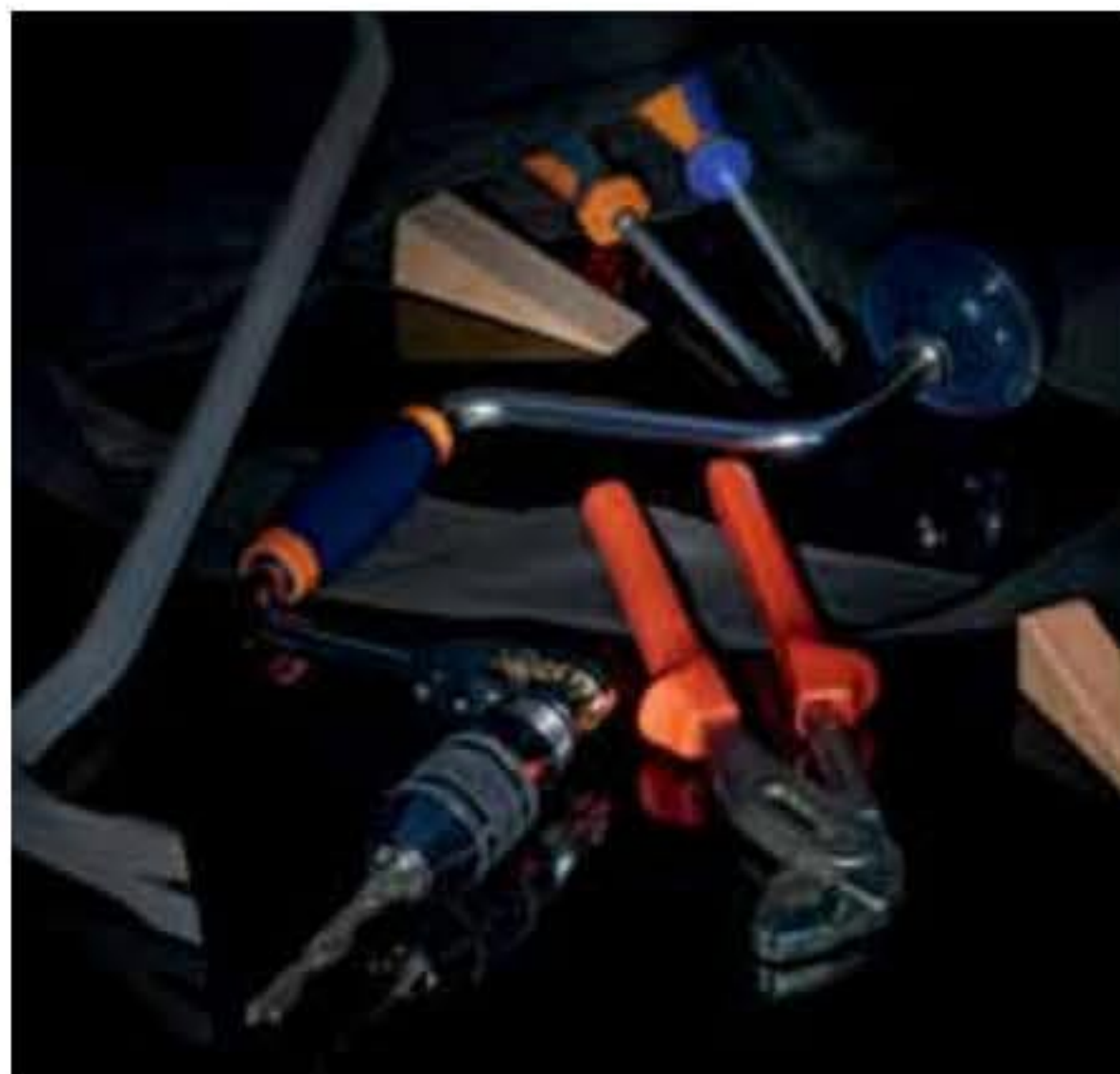
Illustration de droite : outil de cambriolage selon la classe de sécurité CR 3
